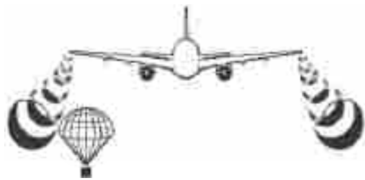
图 5 空投伞边缘接触尾涡涡核半径处的位置示意图 Fig. 5 Schematic diagram of edge of airdrop parachute at radius of wake vortex nucleus
