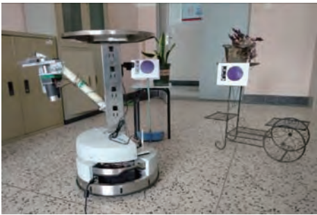
图 5 智能浇花机器人自动寻找并接近盆栽
